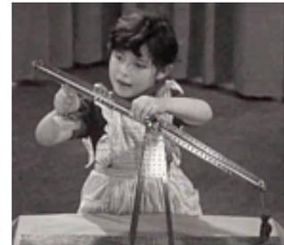
Les facteurs en jeu sont donc les poids  $P_1$  et  $P_2$  des objets  $O_1$  et  $O_2$  suspendus de chaque côté du balancier, l'augmentation ou la diminution de ces poids  $P_1$  et  $P_2$ , les distances  $L_1$  et  $L_2$  de  $O_1$  et  $O_2$  par rapport au milieu (ou aux deux extrémités) du fléau, et l'augmentation ou la diminution de ces deux distances.
